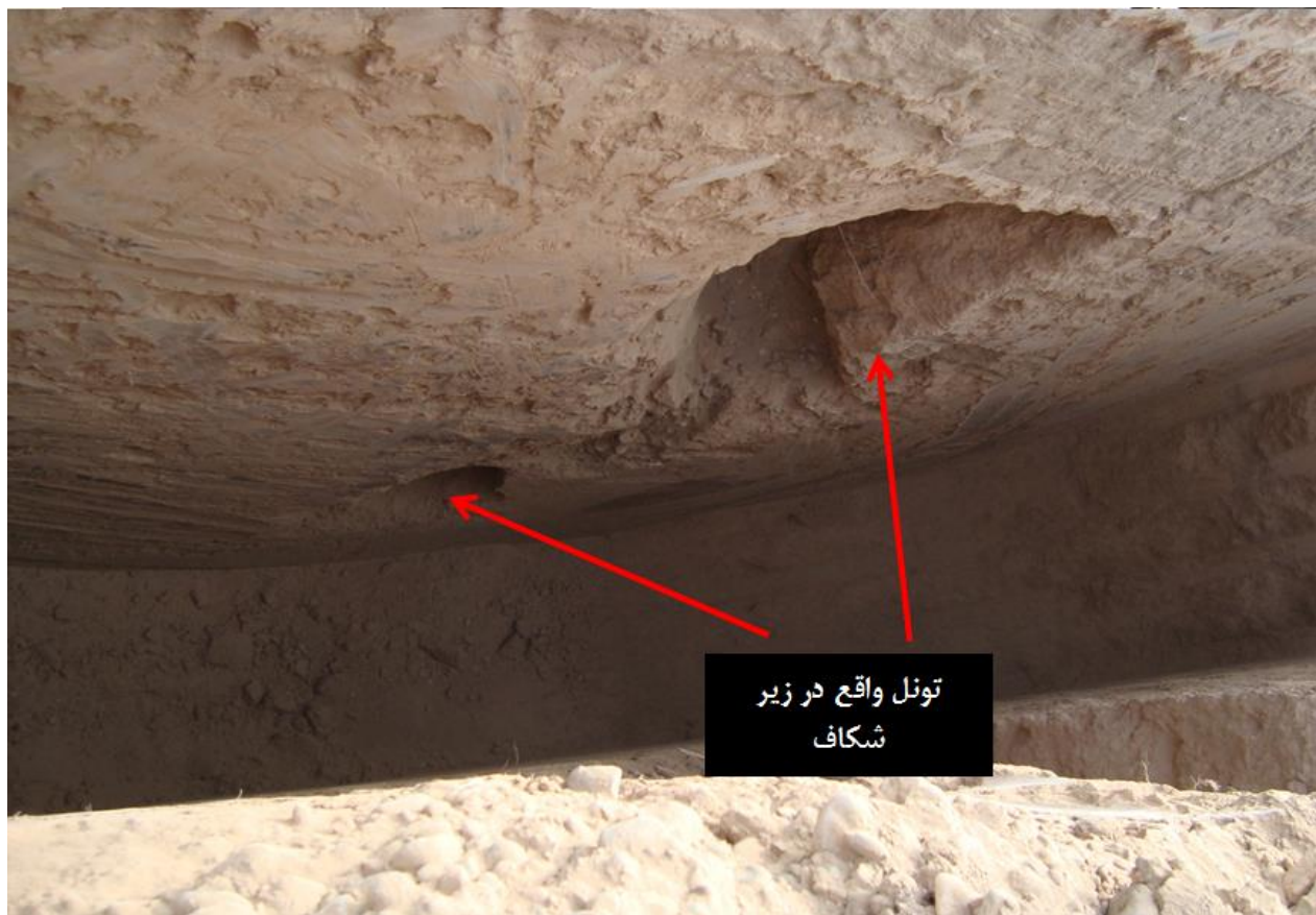
شکل ۱۳- نمونه ای از وجود تونل های ناشی از فرسایش در زیر شکاف های مشاهده شده در روی سطح زمین
